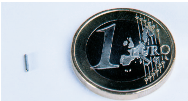
Una semilla yodo 125 tiene una longitud de 4,5 mm y un diámetro de 0,8 mm
